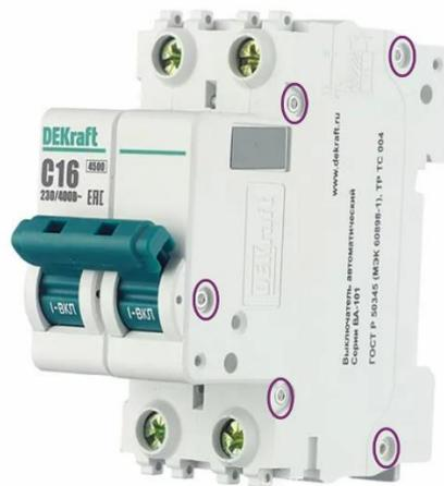
**5 сплошных монолитных заклепок (BA101)** повышают прочность конструкции и обладают повышенной крепостью по сравнению с полыми, а также исключают возможность раскрытия аппарата при повышении предельного усилия затяжки клеммных зажимов.
