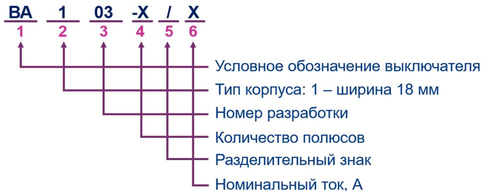
Рисунок 1. Структура условного обозначения
