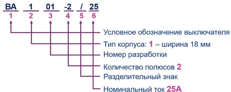
Рисунок 2. Пример условного обозначения
