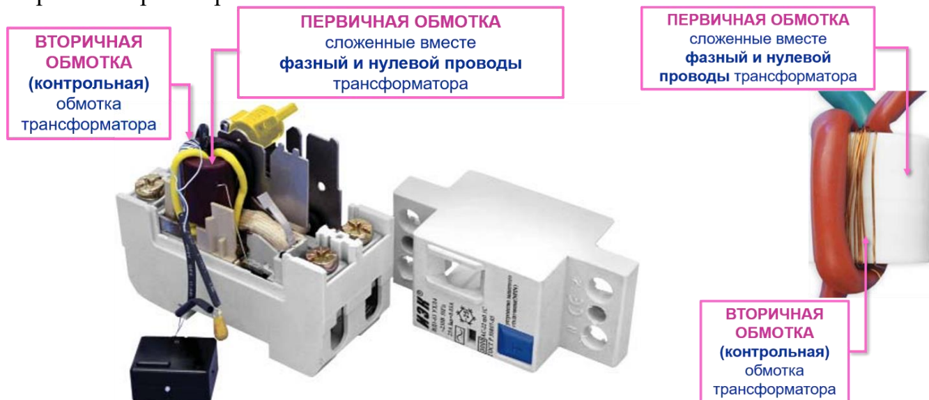
Рисунок 1. Обмотки дифференциального трансформатора тока
