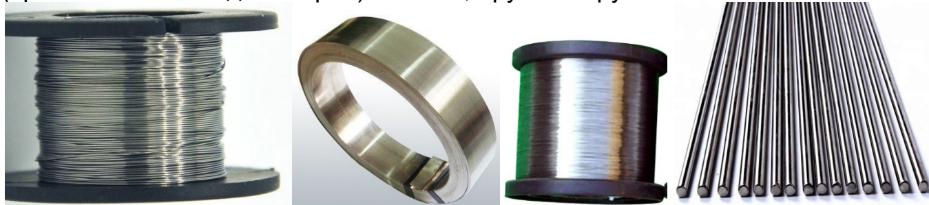
Рисунок 5. Формы выпуска нихрома (слева направо): проволока, нить, лента, прутки
